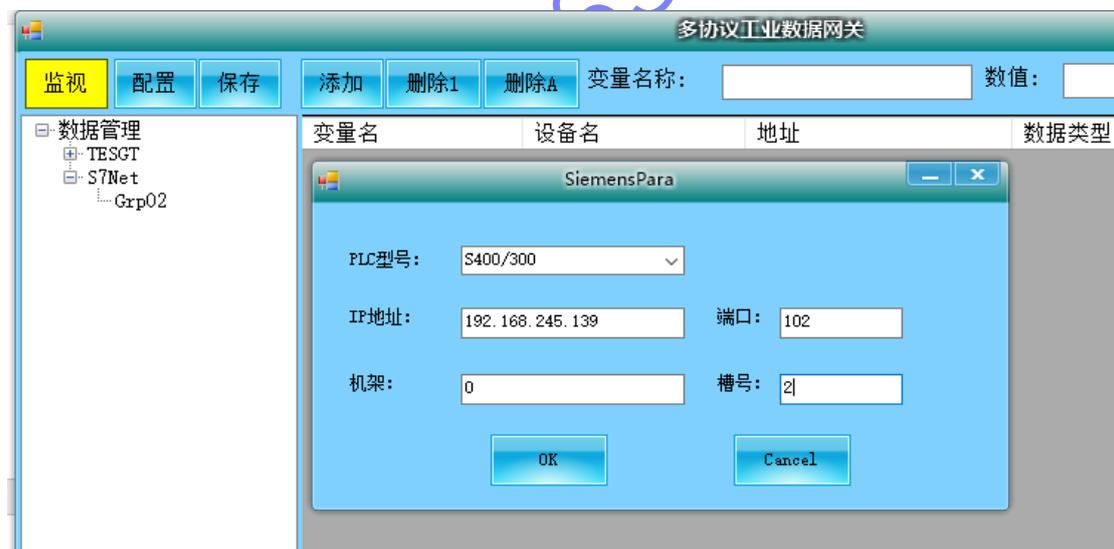
根据自己的 PLC 类型进行选择 1200,1500,300,400,smart 等，然后设置好 IP 地址，CPU 的机架号，槽号等（西门子 plc 缺省端口都是 102），点击 OK 即可，说明与该 PLC 建立连接的参数设置完毕。
